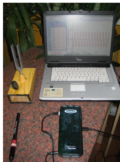
3. attēls. Skaņas viļņa ieraksts ar mikroфона sensoru.
