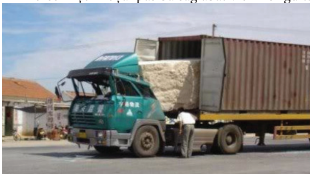
Attēlā kravas automobiļa avārija pēc straujas bremzēšanas – krava deformējusi auto kabīni
